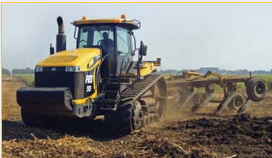
În Malawi, un model MT865C efectuează o adâncire a brazdei de 600 mm.
