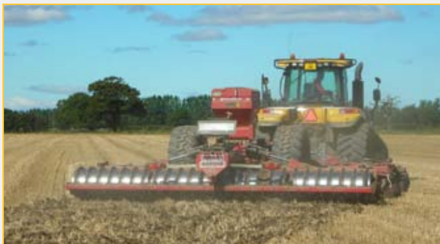
Adâncirea brazdei cu un Sumo Quatro care deține trei grupuri de discuri ce adâncesc brazda la 30 cm plus mașină de snopi, îndepărtează astfel compactarea, lăsând în urmă un pat germinativ dintr-o singură trecere.
